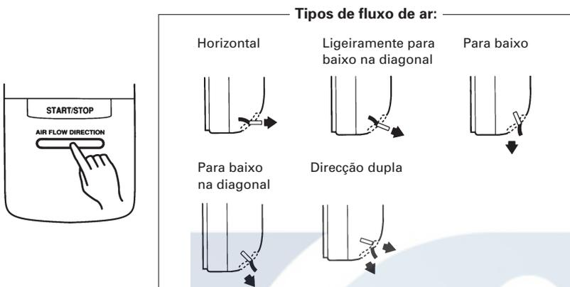
Para aumentar a eficácia dos modos de desumidificação e refrigeração, as abas de direcção do fluxo de ar devem ser colocadas dentro dos seguintes limites:
