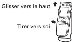
③ Pour retirer la télécommande (contrôle télécommande en main).
